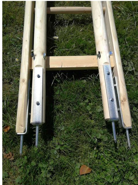
*Klemmsicherung für Pfahlstützen*
